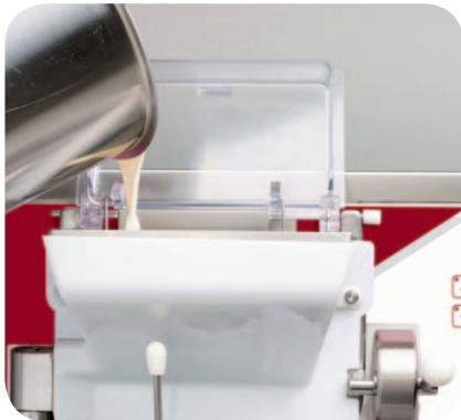
**Agitateur horizontal** - Les ingrédients sont versés dans la trémie du cylindre supérieur. La vitesse de rotation élevée permet la dispersion complète des ingrédients secs.
